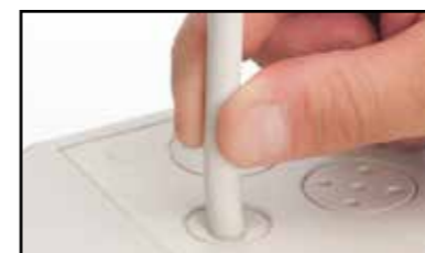
Samotěsnící membránové průchodky navíc umožňují přímou instalaci kabelu, aniž by bylo nutné vrtat otvor či odlamovat plastové záslepky
